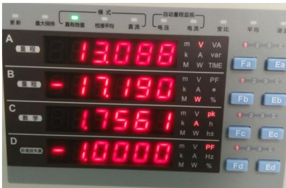
图 4.6 电流钳反接测试结果
