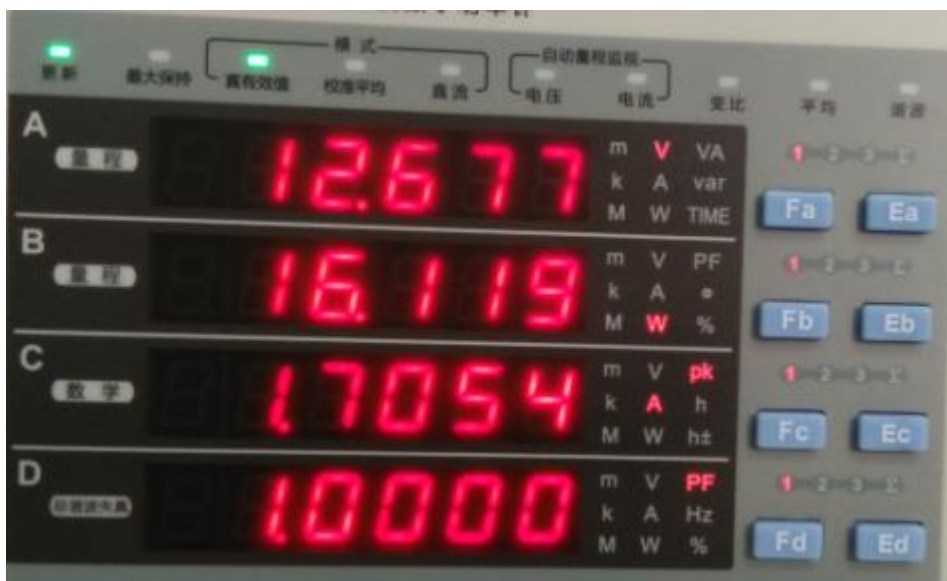
图 4.5 电流钳正接测试结果
